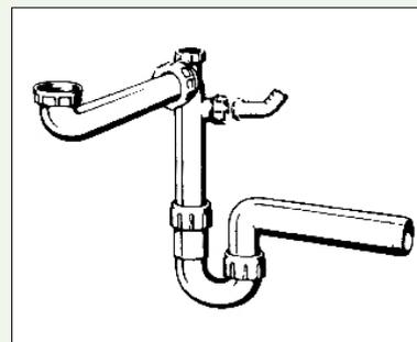
**Geberit-Sifon mit schwenkbarem Abgang**
