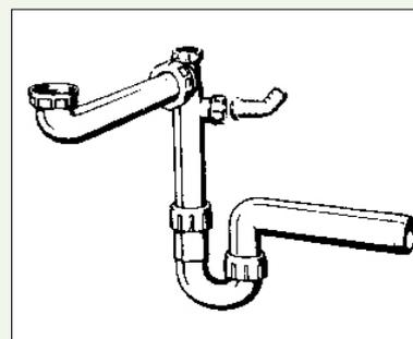
**Viega-Sifon mit schwenkbarem Abgang**
